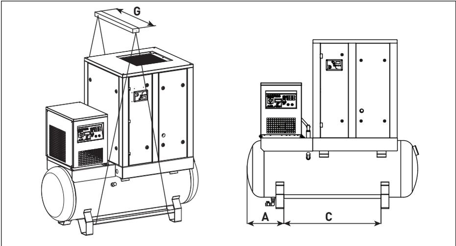
Рис. 3.1.2. Схема для такелажных работ AR07..-AR22, ARD07..-ARD22.
