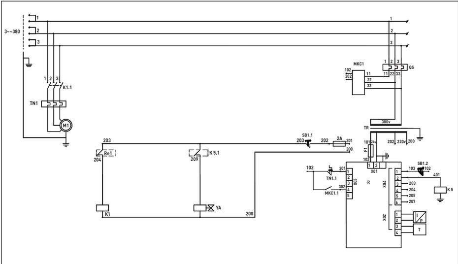
Рис. 2.6.1. Схема электрическая A07..., AR07..., ARD07.\*
