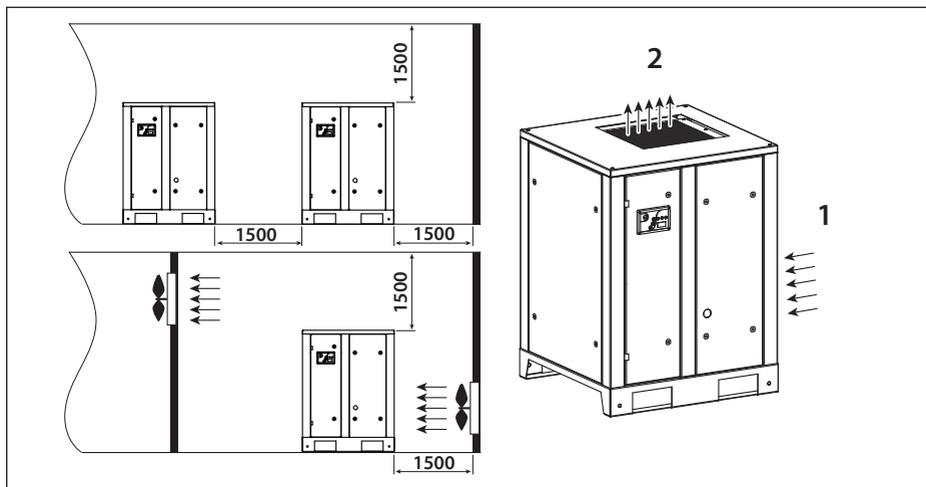
Рис. 3.3.1. Схема установки компрессора А07.. – А22.
