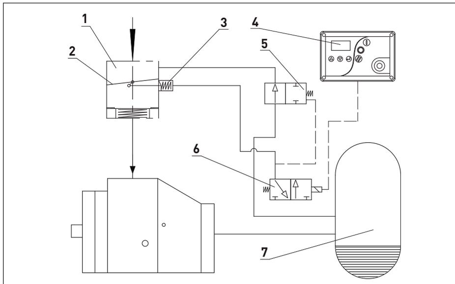
Рис. 2.5 Система регулировки
