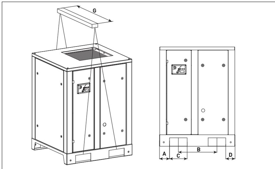
Рис. 3.1.1.1. Схема для такелажных работ А07.. – А22.
